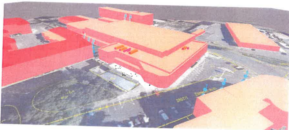
Obr. č. 5 výpočetní model: východní pohled – zdroje hluku jsou označeny růžovými body, výpočtové body jsou označeny čísly
