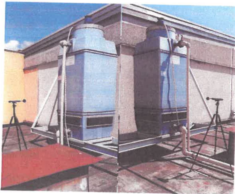
Obr. č. 2 měření hluku mikrochladiče
